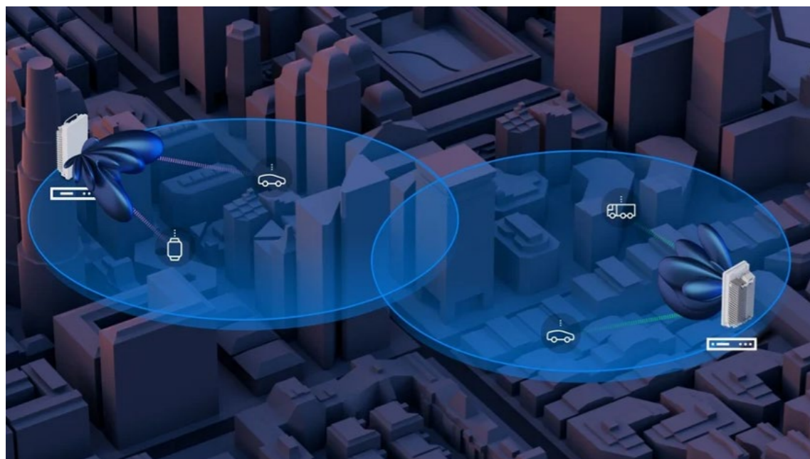
●智感波束技术能够有效减轻小区间干扰，持续提升 5G 网络容量和用户体验（上下图分别是智感波束技术使用前、后的对比）
