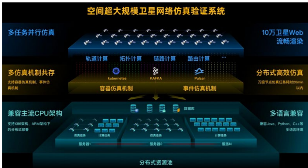
空间超大规模卫星网络仿真验证系统架构示意图
