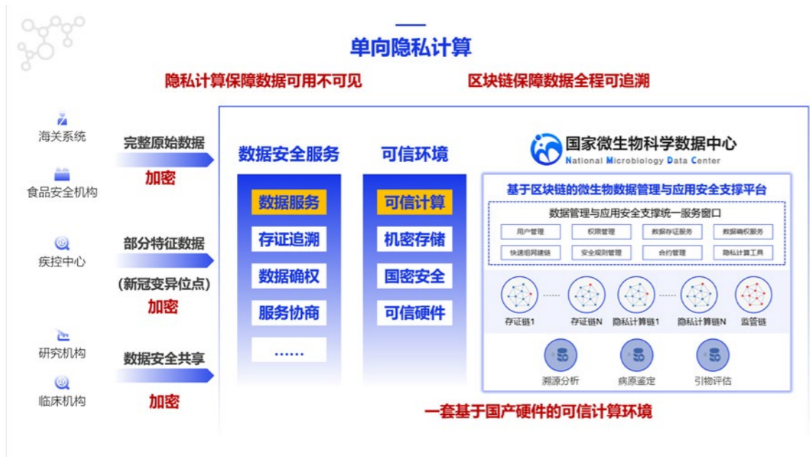
● 国家微生物科学数据隐私计算平台架构示意图 ● Biodata Privacy Computation Platform Architecture Schematic
