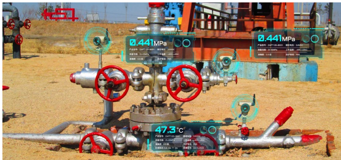
◎ WIA-PA 终端设备实现油井生产状态的实时在线感知
