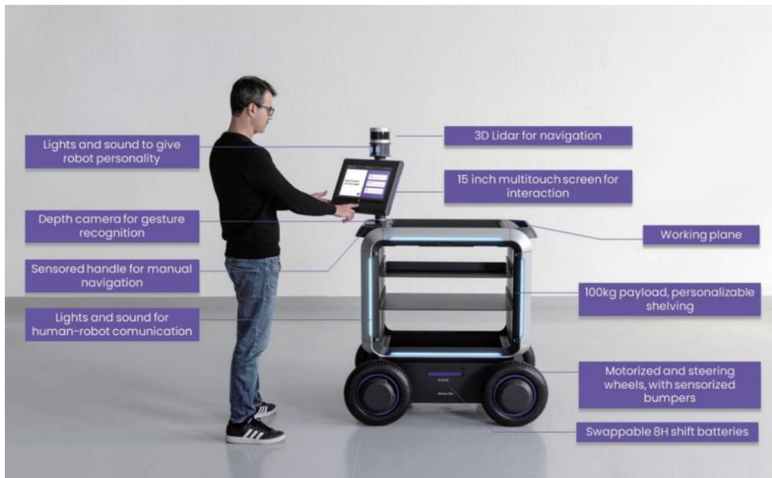
NODE 关键技术要素 Node technological enablers
