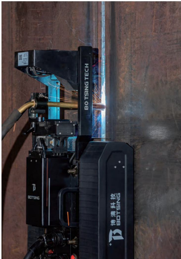
无轨导全位置爬行焊接机器人 - 立焊 Track-Free All-Position Crawling Welding Robot - Vertical Welding
