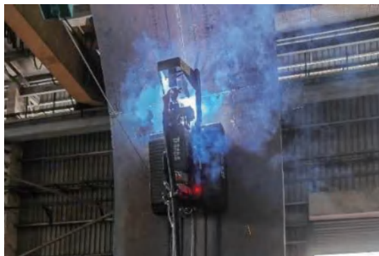
无轨导全位置爬行焊接机器人 - 环焊 Track-Free All-Position Crawling Welding Robot - Girth Welding
