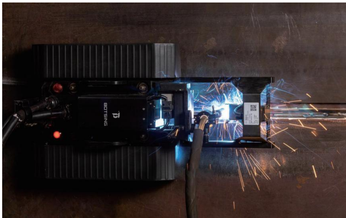
无导轨全位置爬行焊接机器人 横焊 Track-Free All-Position Crawling Welding Robot - Horizontal Welding
