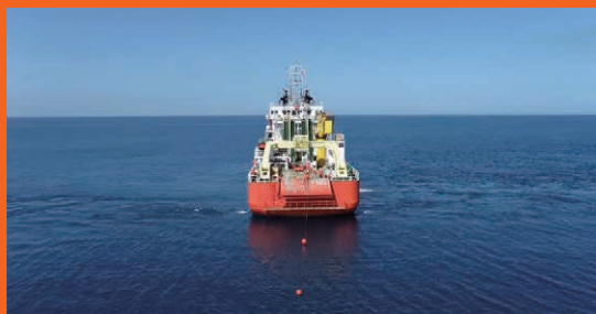
烽火通信自有海缆施工船 在菲律宾海域进行浮球登陆施工图
